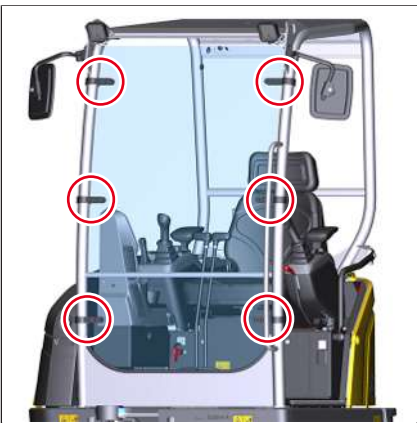
pav. 107: Apsaugos nuo atplaišų montavimas
