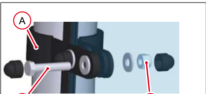
pav. 108: Apsaugo nuo atplaišų montavimo kampas
